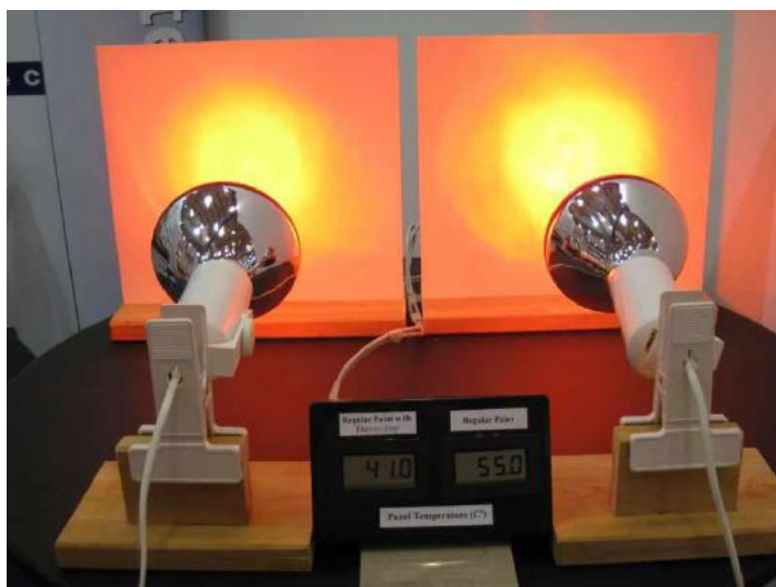
Figure 3. Le rayonnement thermique infrarouge et de la différence de température du panneau
