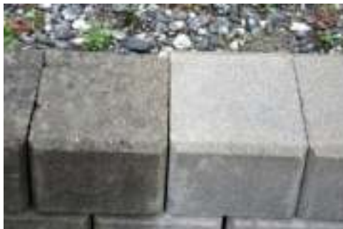
Partie de gauche non traitée, à droite, surface traitée avec SurfaShield C
